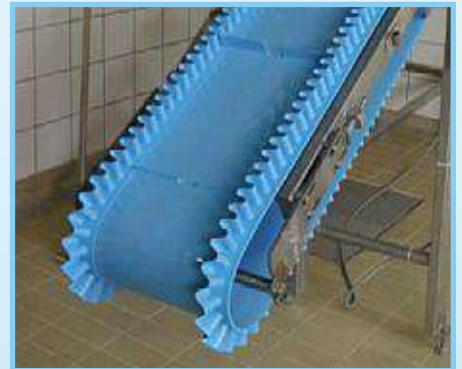
Băng tải SuperDrive TM với tai bèo và gờ đặc biệt
