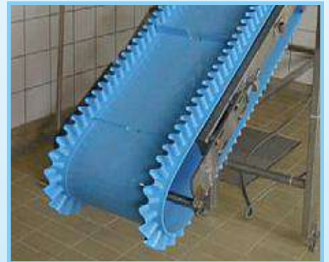
Banda SuperDrive™ con paredes y separadores laterales
